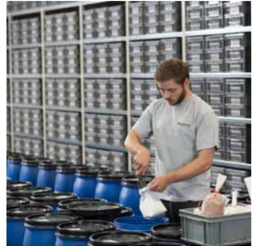
Farbe durch und durch. Mit ihrer extrem feinen Pulverform sorgen Metalloxide für eine optimale Durchfärbung aller keramischen Produkte. Die Farbnuancen erstrecken sich von hellbraun bis schwarzbraun, hellrot bis dunkelrot oder hellgrau bis dunkelgrau. Durch oxidierendes oder reduzierendes Brennen und auch durch Mischen untereinander erweitert sich das Farbspektrum zusätzlich.
