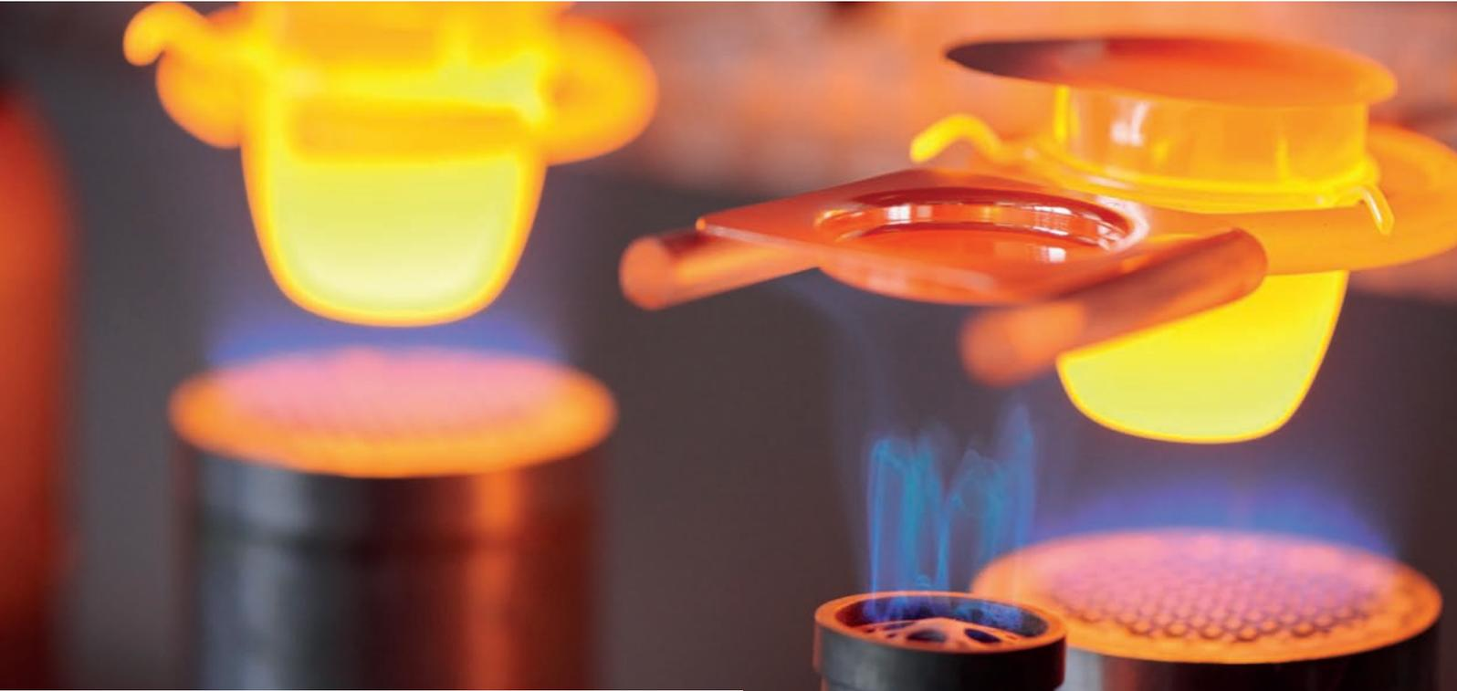
Farbe durch und durch. Mit ihrer extrem feinen Pulverform sorgen Metalloxide für eine optimale Durchfärbung aller keramischen Produkte. Die Farbnuancen erstrecken sich von hellbraun bis schwarzbraun, hellrot bis dunkelrot oder hellgrau bis dunkelgrau. Durch oxidierendes oder reduzierendes Brennen und auch durch Mischen untereinander erweitert sich das Farbspektrum zusätzlich.
