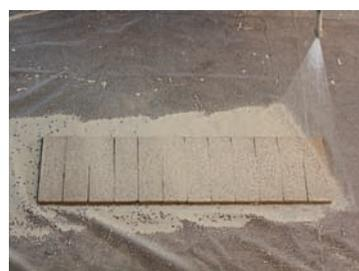
Laborversuche für die maschinelle Applikation mittels „Airless“-Sprühtechnik.
